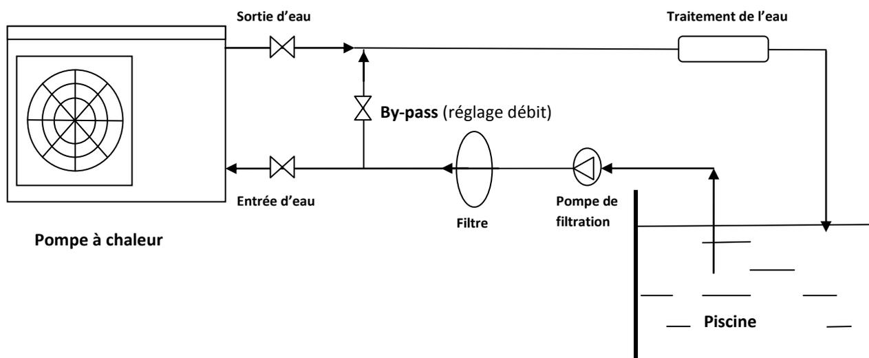
**NOTA :** La pompe à chaleur est livrée avec deux raccords unions diamètre 50, 4 cylindres blocs, un récupérateur de condensat, un moniteur de commande et son coffret, une notice. Le reste de l'installation : vannes, by-pass, pompe, etc., est à fournir par l'installateur.
